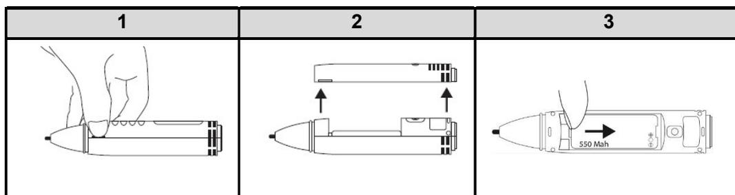
Insérez le bout de votre doigt dans l'encoche pour ouvrir le compartiment de la batterie.
