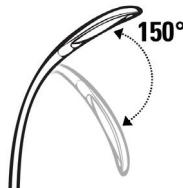
De hals van de lamp kan verticaal worden ingesteld (omhoog/omlaag) binnen een hoek van 150 graden.
