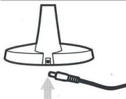
Schließen Sie den Adapter in die hintere Öffnung des Lampensockels und stecken Sie den Stecker in eine Steckdose.
