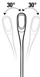
Het hoofd van de lamp kan zijwaarts worden aangepast (rechts/links) binnen een hoek van 60 graden (30 graden naar links en 30 graden naar rechts).
