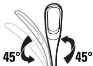
Der Lampenhals kann horizontal gedreht werden (rechts/links) innerhalb eines 90 Grad-Winkel (45 Grad nach links und 45 Grad nach rechts).
