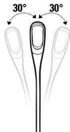
Der Lampenkopf kann seitwärts angepasst werden (rechts/links) innerhalb eines 60 Grad-Winkel (30 Grad nach links und 30 Grad nach rechts).
