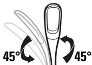
Le col de la lampe peut pivoter horizontalement (droite / gauche) dans un angle de 90 degrés (45 degrés vers la gauche et 45 degrés vers la droite).
