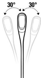
La tête de la lampe peut être ajustée latéralement (droite / gauche) dans un angle de 60 degrés (30 degré à la gauche et 30 degrés à la droite).
