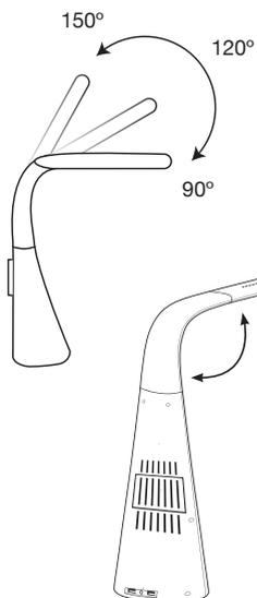
Le col de la lampe peut être ajusté verticalement (haut-bas) dans un angle de 150 degrés.
