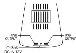
Sluit de adapter in het achterste gat van de lampvoet aan en steek de stekker in een stopcontact.
