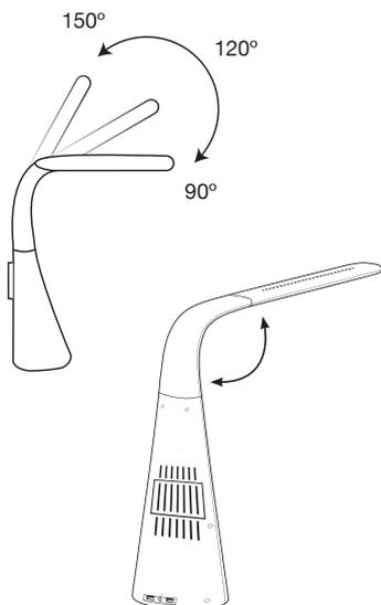
Der Lampenhals kann vertikal eingestellt werden (hoch/ runter) innerhalb eines 150 Grad-Winkel.
