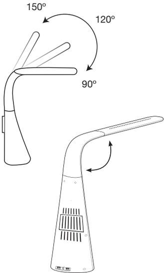
De hals van de lamp kan verticaal worden ingesteld (omhoog/omlaag) binnen een hoek van 150 graden.
