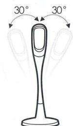
Het hoofd van de lamp kan zijwaarts worden aangepast (rechts/links) binnen een hoek van 60 graden (30 graden naar links en 30 graden naar rechts).
