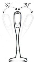
La tête de la lampe peut être ajustée latéralement (droite / gauche) dans un angle de 60 degrés (30 degré à la gauche et 30 degrés à la droite).
