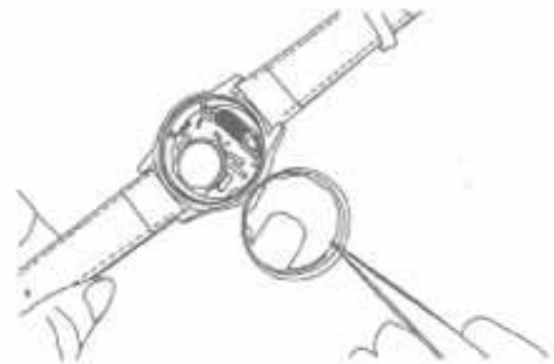
step 2. take out the plastic holder 2. Entfernen Sie die Werkhalterung
