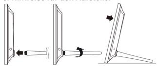
Die Halterung ist an die Rückseite des Produktes angeschlossen. Öffnen Sie die Halterung, bevor Sie sie stabil auf den Tisch platzieren. Drücken Sie die Halterung in den Schlitz, bevor Sie sie aufheben. Siehe vorstehende Abbildung.
