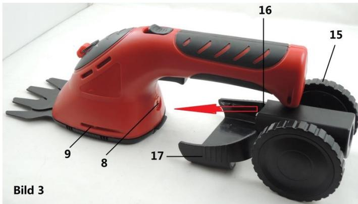
1. Zum Montieren der Räder (15) schieben Sie die Radhalterung (17) entlang der seitlichen Führungsnuten (9) bis zum Anschlag am Gerät entlang. Zwischen Stecker (16) und Gerätebuchse (8) ist dann automatisch ein Kontakt hergestellt.
