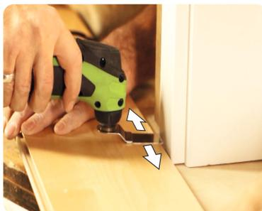
Ein rotierendes Sägeblatt (Kreissäge, Winkelschleifer) schleudert Späne und Staub weg. Ein oszillierendes Sägeblatt - wie beim MultiTool - macht das nicht. Bei einem tiefen Tauchschnitt (z.B. um ein Schloss einzusetzen), sollten Sie von Zeit zu Zeit die Arbeit unterbrechen, um die Rückstände mit einem Pinsel oder Staubsauger zu entfernen. Staub und Späne behindern die Effektivität des MultiTools.
