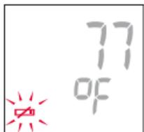
Bei zu geringer Batteriespannung warnt die Batteriestandswarnung,
