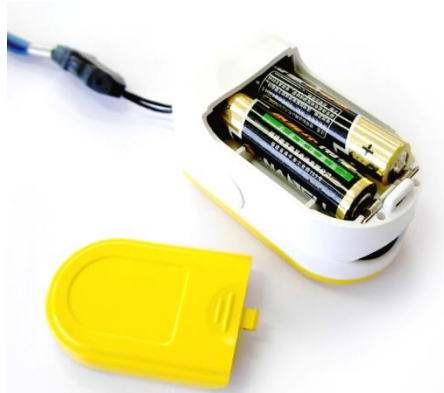
Figuur 3. Installatie van de batterijen
