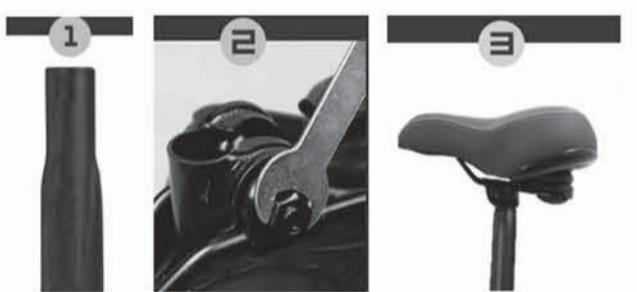
**Option 2** (Tige de la selle du vélo comme celle illustrée à la Fig.A): Retirez les écrous des deux côtés de nouvelle selle avec une clé (Fig.B), retirez la barre transversale et les autres pièces (Fig.C). Assemblez la nouvelle selle sur le support de la selle, ajustez l'angle de tirage de la selle et serrez la vis originale du support de la selle (Fig.E). L'installation est terminée (Fig.F).
