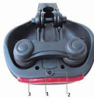
1. Batterijcompartment (1x3V CR2032 Er wordt batterij meegeleverd)
