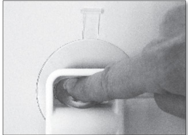
3) Den Verschlussstopfen von der Oberseite in die Plattenöffnung bündig eindrücken.
